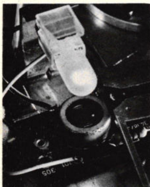
Opto-elektronische afschakeling van de AEG-Telefunken draaitafel S 500 HiFi en 600 HiFi. Zodra de toonarm in de uitloop-groef belandt, wordt hij opgeheven en teruggezwengeld en stopt de motor, zonder dat er enige mechanische kracht op de arm wordt uitgeoefend.
