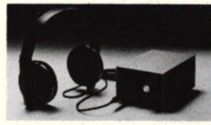
De „Ruimteklank" hoofdtelefoon van Technics (= National) is een gewone stereo-hoofdtelefoon, die zijn geluid uit een stereo-versterker krijgt via een speciale adapter, die door een ons onbekende schakeling een quadrofonisch aandoend akoestisch-ruimtelijk geluidsbeeld geeft. Men noemt het een Ambiance Phone System, dat zowel platen als banden en FM uitzendingen als uitgangsmateriaal kan gebruiken, zonder dat er kunsthoofd-toestanden aan te pas komen.
