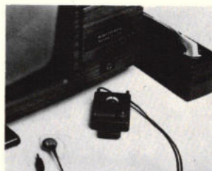
Het infrarode ontvangerje van Grundig, dat om de hals wordt gedragen en van een in het oor gestoken telefoontje gebruik maakt.
